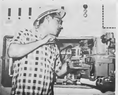
UN ELECTRICISTA, arriba, ta instala windings den un stator. Aki riba un rotor den su caha ta worde hazi. Motor ta parti integral di control pa medio di instrumento, abao.
